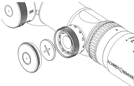
Abb. 6: Batteriewechsel
