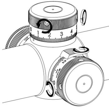
Abb. 14: Nullen des Zielfernrohres - Lösen der Schrauben
