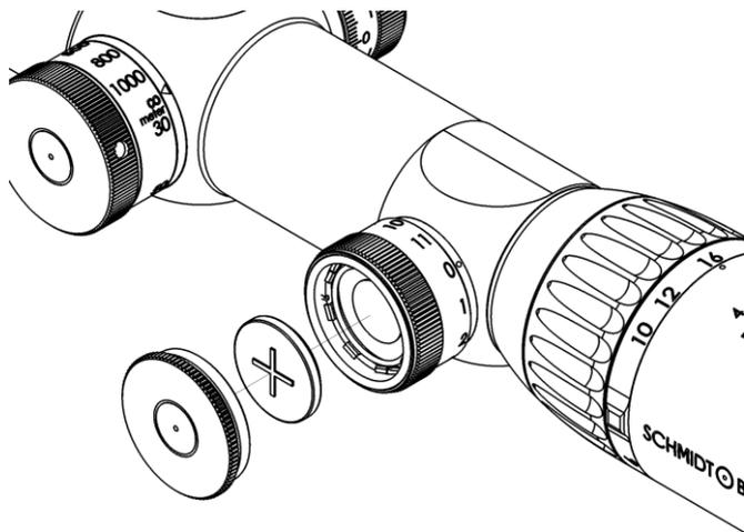
Abb. 6: Batteriewechsel
