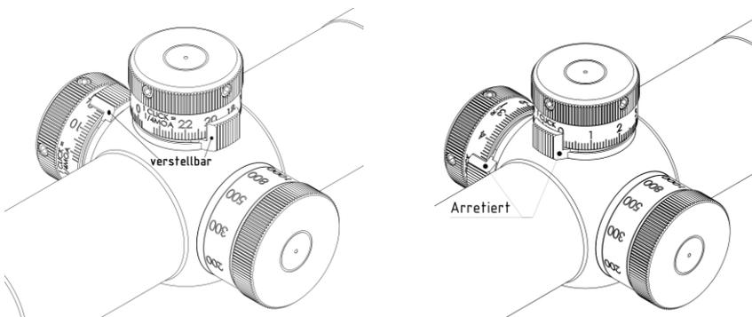
Abb. 13: Arretierung der Türme: verstellbar und arretiert
