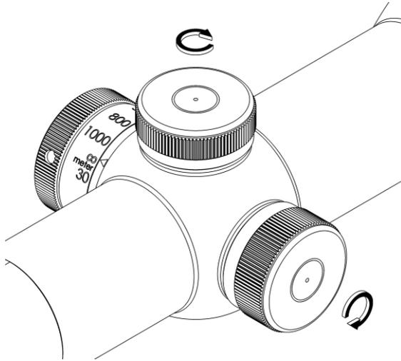
Abb. 8: Entfernen der Kappen von Höhen- und Seitenturm
