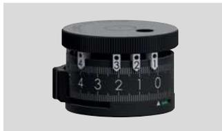
La torretta ST II-B offre la BDC più rapida e precisa per il tiratore/cacciatore. La torretta è simile alla ST II, ma consente di compensare facilmente i flussi come il cambio di munizioni, l'uso di un silenziatore o il cambiamento delle condizioni ambientali. È possibile spostare gli indicatori di posizione con i numeri 1-6 (che corrispondono a 100-600 m) sulla parte esterna della torretta e fissarli nella posizione desiderata. Un altro vantaggio della ST II-B è la possibilità di
